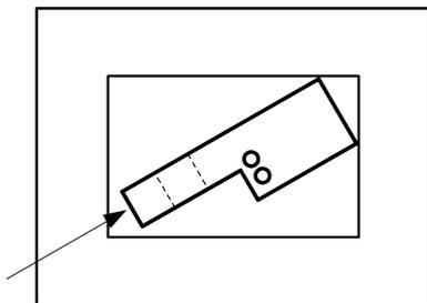
Testspule vertikal positionieren
