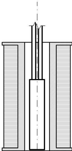
Testspule vertikal positionieren
