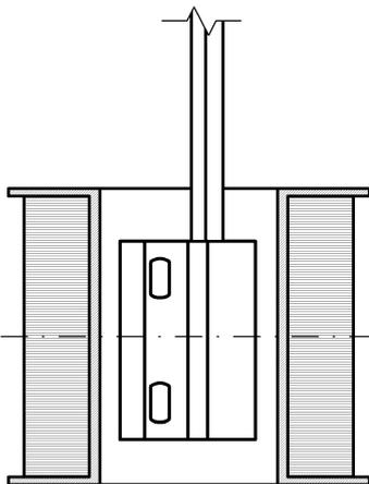
Testschleife vertikal positionieren
