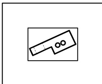
Reedsensor diagonal zentriert in der Testschleife
