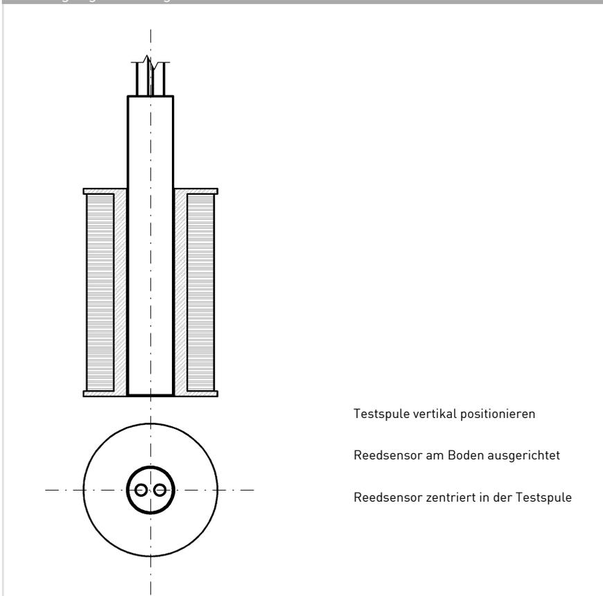
Testspule vertikal positionieren
