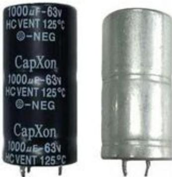
Die neue HC Serie von CapXon sorgt mit einem neuen mechanischen Design, mit zusätzlichen Sicken im Gehäuse und verstärkten Anschluss-Pins, für einen sicheren Betrieb bei hohen Vibrationsbelastungen. Die Elko-Serie ist gemäss dem Standard JIS-C51015-1 bis zu 30 g belastbar. Erhältlich sind die Kondensatoren mit Nennspannungen von 25 bis 80 VDC und Kapazitäten von 820 bis 1800  $\mu\text{F}$ , in einem nutzbaren Temperaturbereich von  $-55$  bis  $+125$  °C.
